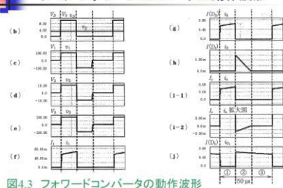
図4.3 フォワードコンバータの動作波形
