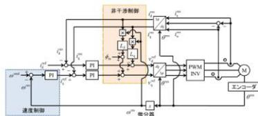
図 4-1. 速度制御ブロック線図
