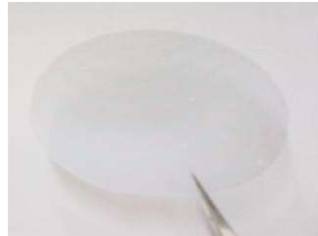
\text{Ga}_2\text{O}_3 薄膜 基板: サファイヤ (直径4インチ)
