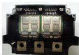
昇圧コンバータ PM400DJA120 (三菱電機)
